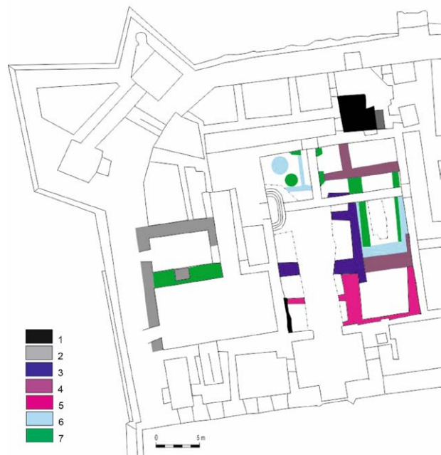
Nitra-hrad, biskupský palác. Pôdorys odkrytých architektúr v paláci a na nádvorí paláca. Legenda: 1 – predrománska architektúra (9. až 1. pol. 11. stor.); 2 – románsky palác (12.–13. stor.); 3–5 – gotické murivá (2. pol. 13. až 1. pol. 15. stor.); 6 – neskorogotická fáza (2. pol. 15. stor.); 7 – renesančná fáza (2. pol. 16. stor.).
