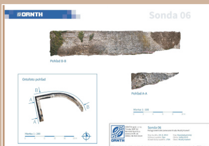
Fotogrametria obvodového plášť a tzv. východnej terasy
