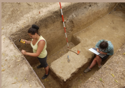
Meranie profilu sondy príručným kappametrom
